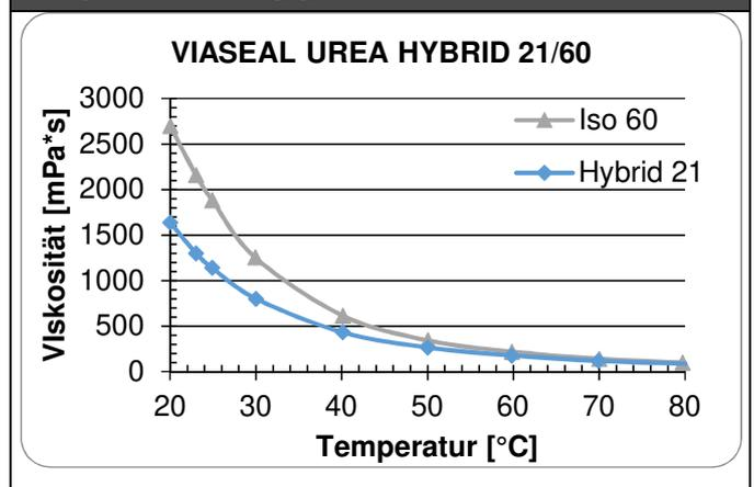
Produkt 02321600 2-K Polyurea/PU Hybrid-Spritzabdichtung, hochelastisch, MV 1:1, lösemittelfrei
