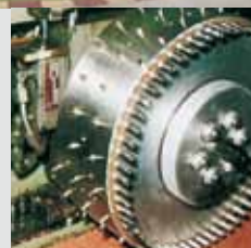
Prüfung der Spikes-Festigkeit
