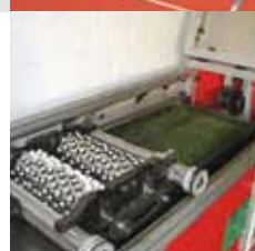
Prüfung der Verschleißfestigkeit von Kunstrasen
