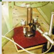
Prüfung der Dauerelastizität
